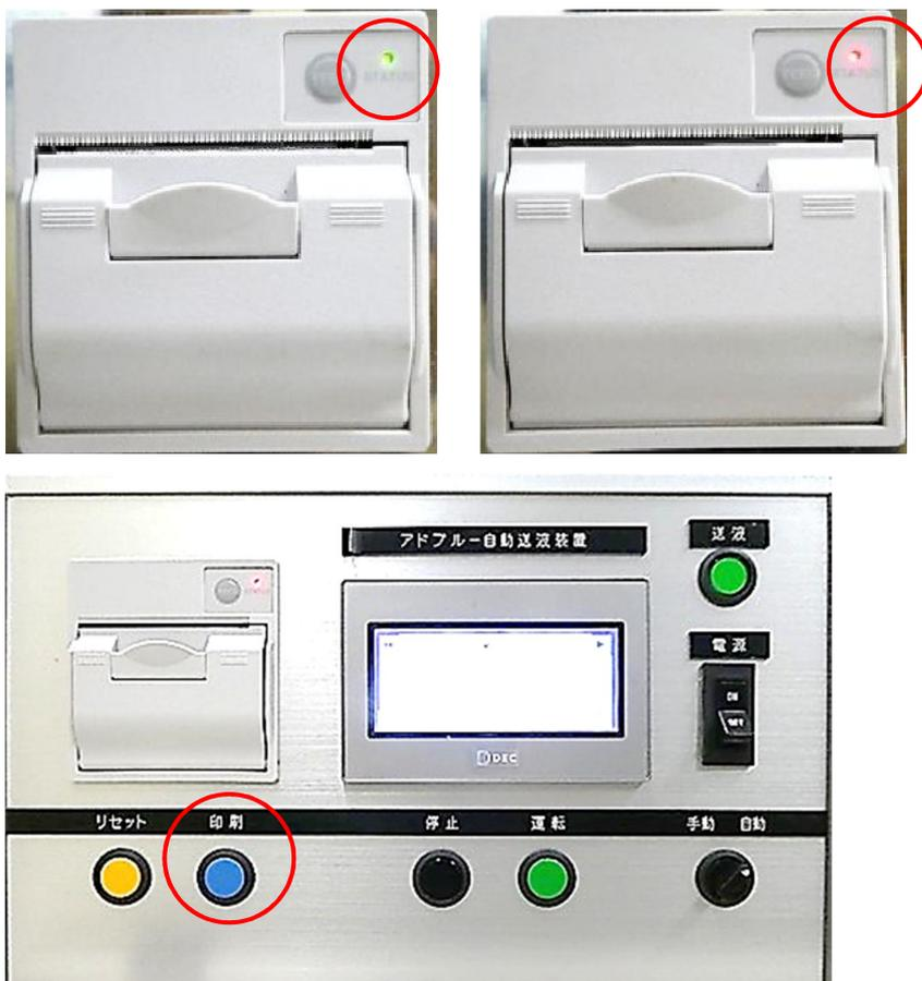
② 計量票が2部(本紙・控)連続して印刷されますので、用紙を上方に持ち上げながら切り離してください。
